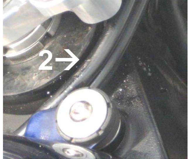
**Bremssleitung (2):** Mitgelieferte Bremssleitung mit neuen Dichtringen montieren. Beachten Sie unbedingt die separat beiliegende Anbauanleitung der Stahlflex-Bremssleitung. Den Bremsschlauch (79cm) mit dem 90° seitlich gewinkelten Anschluss, wie abgebildet, an der Handbremspumpe montieren und mit einem Kabelbinder am Gabelholm befestigen. Den Bremsschlauch wie original durch die Befestigung an der unteren Gabelbrücke führen.
