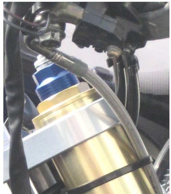
**Kupplungszug (3):** Zug wie abgebildet verlegen und an der markierten Stelle (siehe →) mit dem beiliegenden Schrumpfschlauch gegen Scheuern schützen.
