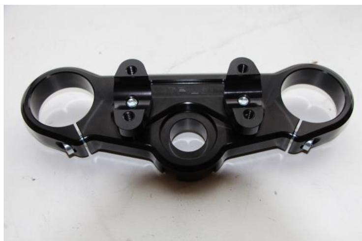
Die Klemmböcke mit den mitgelieferten Schrauben (M10), Schnorr-Sicherungen und Schraubensicherungsmittel an die Gabelbrücke schrauben.
