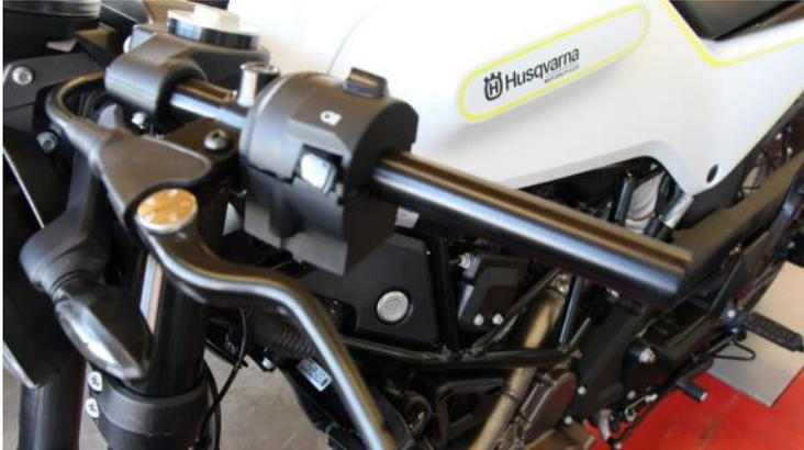
Beide Lenkergewichte lösen und den linken Griffgummi entfernen.
