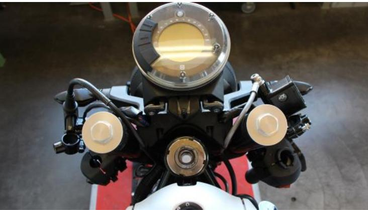
Die Klemmschrauben der Gabelbrücke lösen und die Steuerkopfschraube entfernen.
