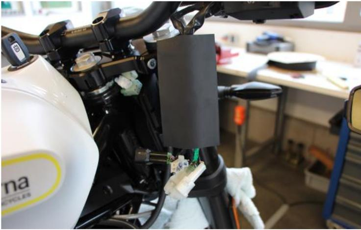
Den beiliegenden Schrumpfschlauch auf beiden Seiten über die Kabel der Schaltarmaturen ziehen.
