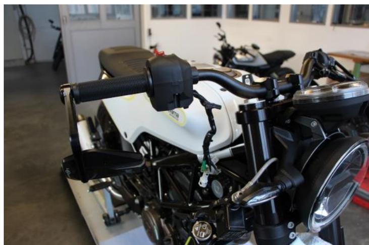
Alle Bedienelemente und Griffarmaturen auf den Lenker schieben und provisorisch vormontieren.
