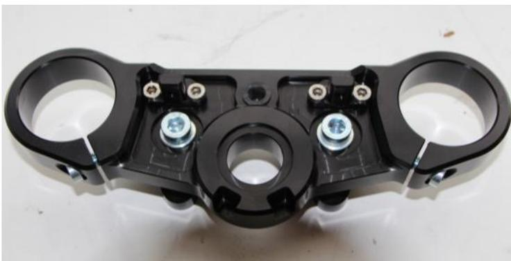
Den Führungsgummi aus der originalen Gabelbrücke entnehmen und mit etwas Fett in die neue Brücke montieren.
