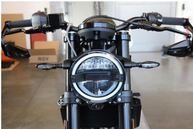
Es ist auf eine funktionsgerechte Lage aller am Lenker befindlichen Bedienteile (z.B. HBZ und Vorratsbehälter...), auch bei vollem Lenkeinschlag, zu achten.
