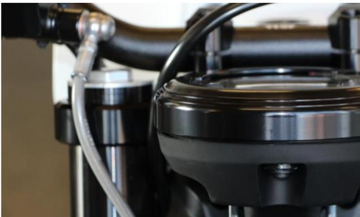
Die Schraube der Bremsleitung an der Handpumpe leicht lösen um den Anschluss zu verdrehen. Danach wieder festziehen.
