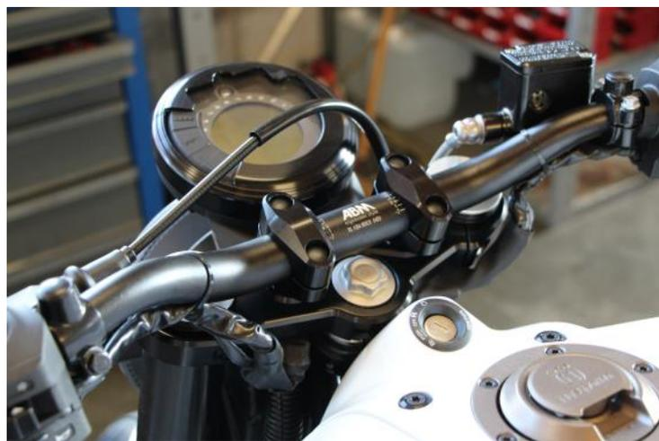
Abschließend die Schrauben der Klemmböcke festziehen und die Abdeckkappen montieren.
