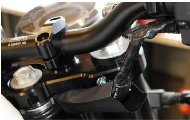
Den Schrumpfschlauch von der Mitte aus beginnend mit einem Heißluftföhn schrumpfen.
