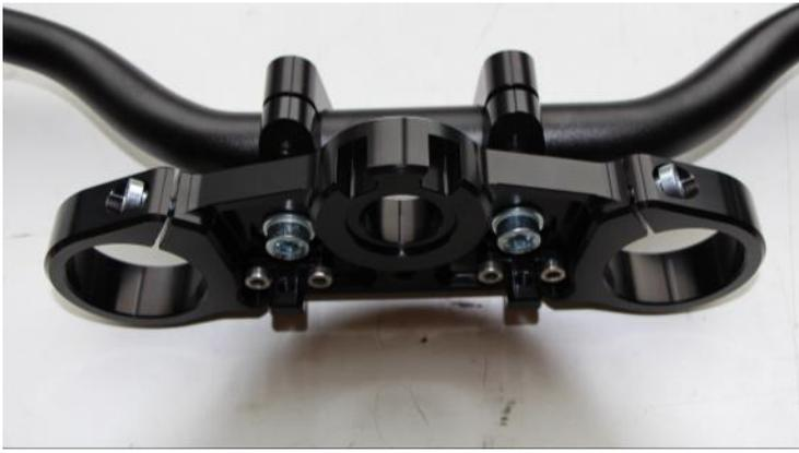
*Tipp: Zur Montage der Klemmböcke zuvor den Lenker einlegen und leicht festklemmen.*
